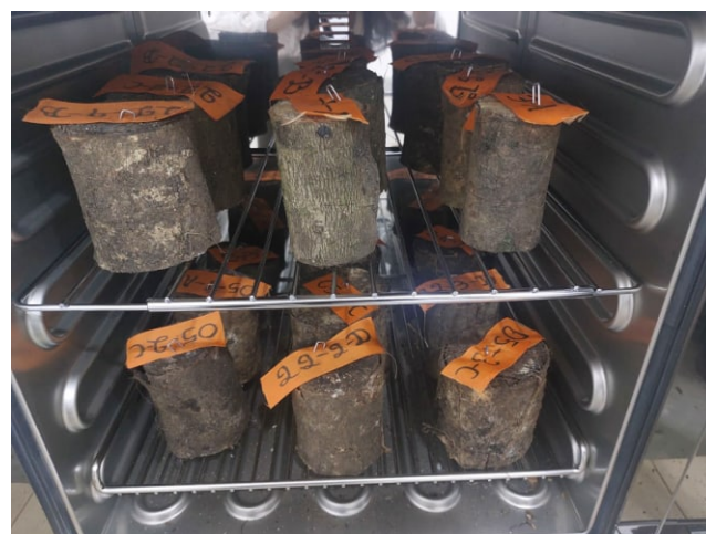
Figura 53: Experimento WP5: secciones de madera cortadas y secadas a 80 °C hasta que la masa permanezca constante.
